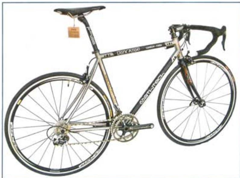
A SINISTRA: Dark angel è il classico telaio ibrido in metallo e carbonio pensato per i ciclisti sensibili al comfort che non vogliono rinunciare alle prestazioni. Il look è affascinante, il diametro delle tubazioni è classico. SOPRA: la bella giunzione dello sterzo. Da notare le guide dei cavi saldate al tubo
