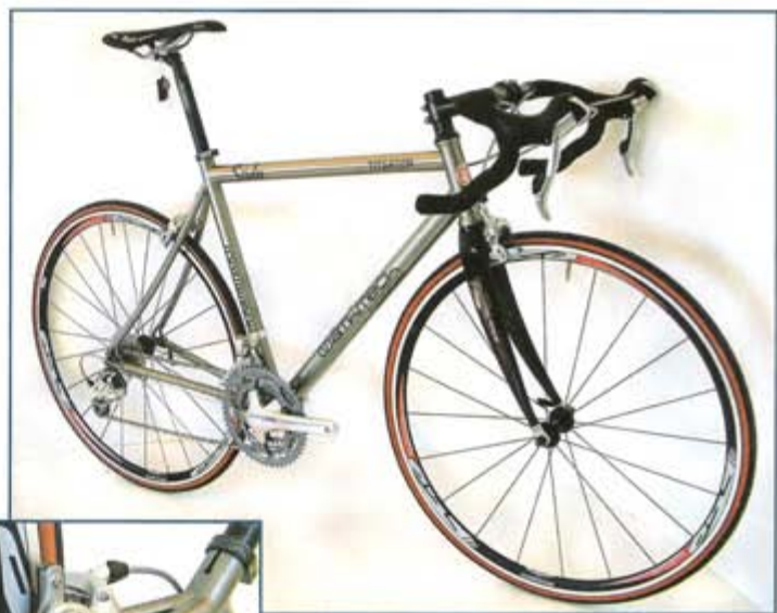
A SINISTRA: Dark angel è il classico telaio ibrido in metallo e carbonio pensato per i ciclisti sensibili al comfort che non vogliono rinunciare alle prestazioni. Il look è affascinante, il diametro delle tubazioni è classico. SOPRA: la bella giunzione dello sterzo. Da notare le guide dei cavi saldate al tubo
