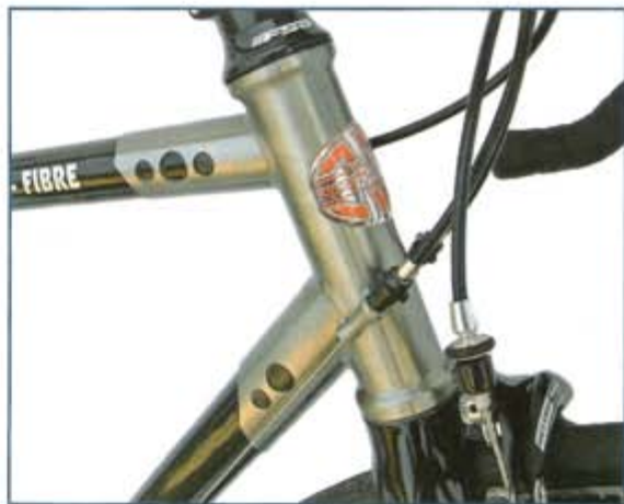
A SINISTRA: Dark angel è il classico telaio ibrido in metallo e carbonio pensato per i ciclisti sensibili al comfort che non vogliono rinunciare alle prestazioni. Il look è affascinante, il diametro delle tubazioni è classico. SOPRA: la bella giunzione dello sterzo. Da notare le guide dei cavi saldate al tubo
